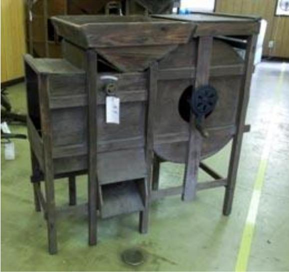
稲や麦などのモミを選別するための道具で、左上の三角形のところから少しずつモミをいれて、右側のハンドルで内部の風車を回して風を起こしてモミを飛ばし、軽いものは遠くへ、重たいものはすぐそばに落ちるようして選別します。
